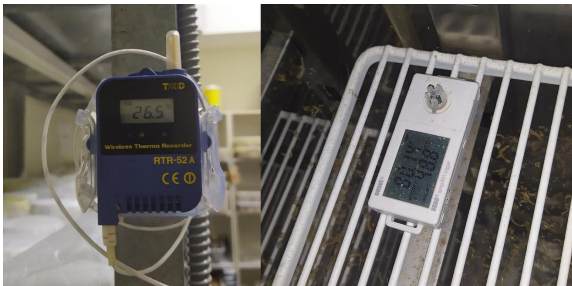
Εικόνα 11: Ειδικά μηχανήματα για την καταγραφή των διακυμάνσεων και τυχόν αποκλίσεων των συνθηκών θερμοκρασίας και υγρασίας (Πηγή: Εργαστήριο Εντομολογίας και Γεωργικής Ζωολογίας)
