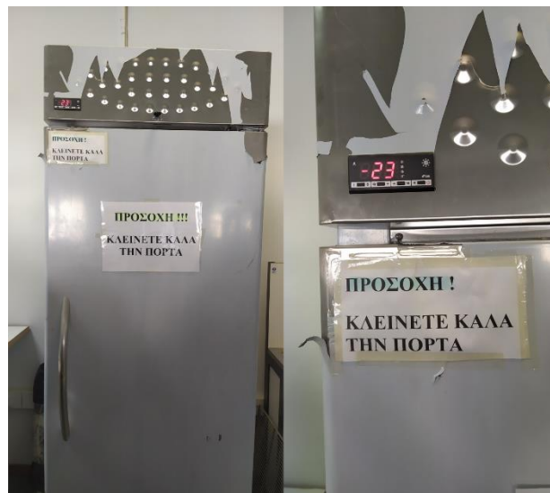
Εικόνα 2: Ψύξη υποστρωμάτων για τουλάχιστον 1 εβδομάδα στους -20^{\circ}\text{C} , για την θανάτωση τυχόν εντόμων που βρίσκονται στο προϊόν (Πηγή: Εργαστήριο Εντομολογίας και Γεωργικής Ζωολογίας)
