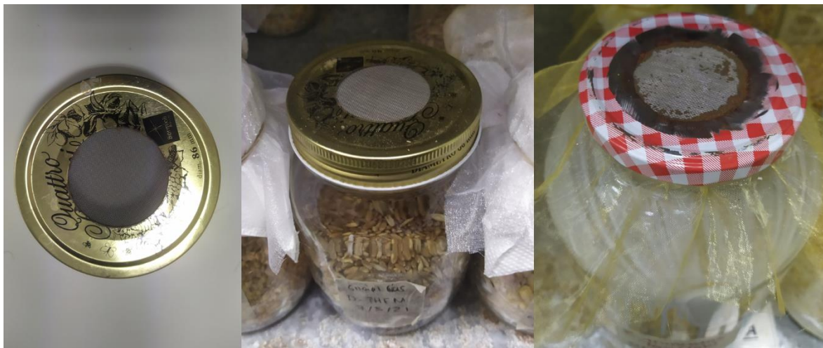
Εικόνα 5: Ειδικά σχεδιασμένο καπάκι με μεταλλική σίτα για τις εργαστηριακές εκτροφές κολεοπτέρων (Πηγή: Εργαστήριο Εντομολογίας και Γεωργικής Ζωολογίας)
