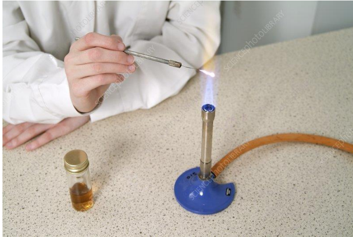
Εικόνα 18: Φλόγα του λύχνου Bunsen για την αποστείρωση των εργαλείων (Πηγή: https://www.sciencephoto.com/media/657248/view/microbiology-culture-preparation )
